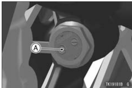
A. Regolatore forza di smorzamento in compressione
