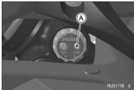
A. Regolatore forza di smorzamento in compressione
