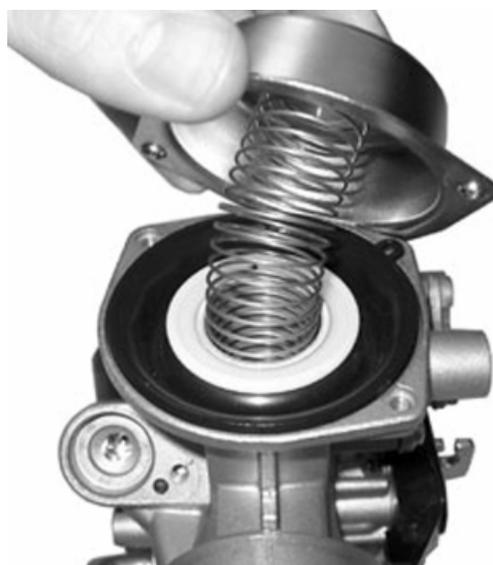
Rimuovere la valvola a depressione completa di membrana.
