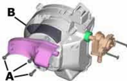
Attraverso un condotto rigido flangiato alla testa l'aria raggiunge il raccordo di scarico, per andare a dare ossigeno ai gas incombusti prima del catalizzatore, favorendo così una migliore reazione del catalizzatore.
