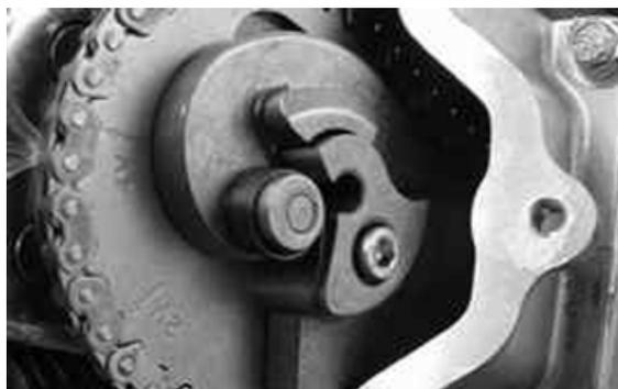
Montare la campana di contenimento utilizzando come riferimento la vite di fissaggio del contrappeso.
