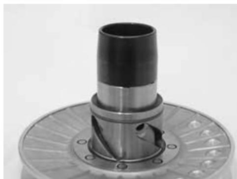
Mediante un ingrassatore a becco curvo lubrificare il gruppo puleggia condotta con circa 6 gr. di grasso, questa operazione deve essere eseguita attraverso uno dei fori all'interno del boccolo fino ad ottenere la fuoriuscita del grasso dal foro opposto. Tale operazione è necessaria per evitare la presenza di grasso oltre gli anelli O-R.
