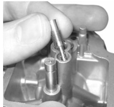
Rimuovere la vite di flusso del minimo con l'anello O-R, la rondella e la molla.
