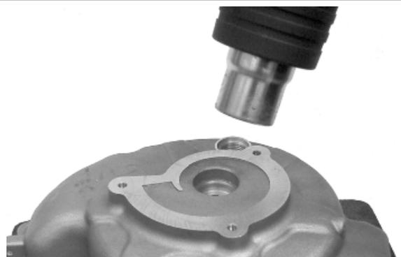
Supportare adeguatamente il coperchio e mediante il punzone componibile, installare contemporaneamente i due cuscinetti fino a battuta.
