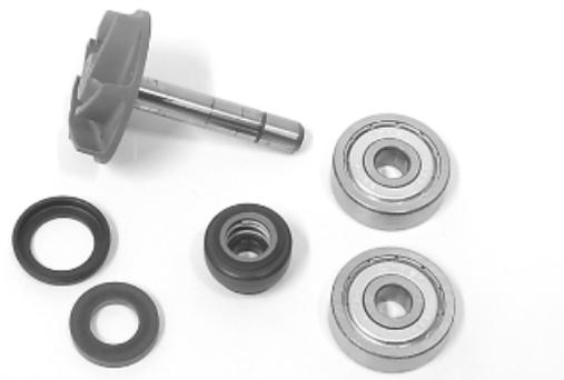
Giunto di trascinamento: Verificare che non siano presenti usure anomale alla sede per il paraolio ed alle cave per la molla di trascinamento.
