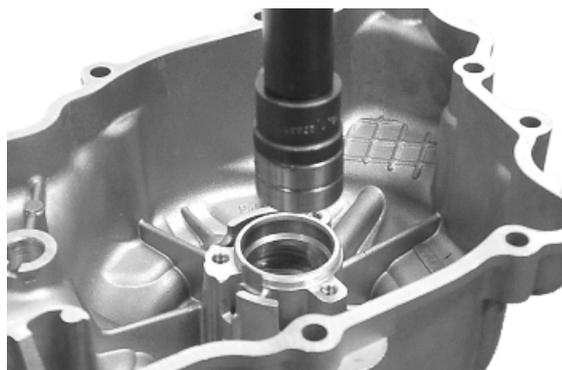
Lasciare raffreddare il carter coperchio volano, quindi montare manualmente la parte statica della tenuta ceramica con la relativa guarnizione in gomma.
