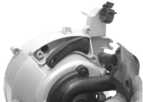
Al rimontaggio procedere con le operazioni in senso inverso allo smontaggio avendo cura di rispettare l'orientamento del manicotto in gomma di collegamento valvola SAS al sistema di scarico
