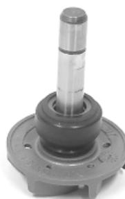
Posizionare il coperchio volano sulla pressa utilizzando la base di appoggio per i cuscinetti facente parte dall'attrezzo specifico. Installare sul pistone della pressa il punzone specifico con la sagoma della girante.
