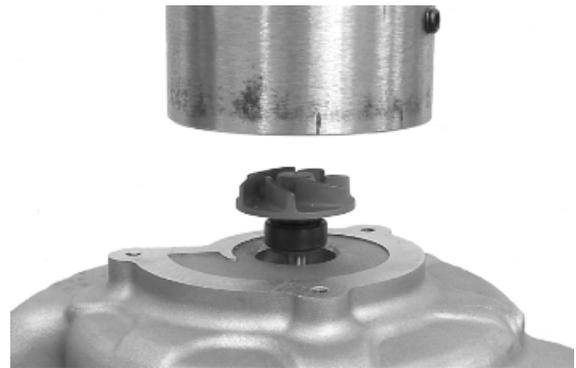
Mantenendo in contatto i cuscinetti con la base di supporto, allineare l'alberino con il pistone della pressa e procedere con il piantaggio. La profondità di piantaggio viene determinata dalla battuta del punzone quando questa viene in contatto con il coperchio del volano.
