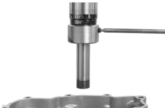
Posizionare il giunto di trascinamento sull'alberino e mediante la pressa piantarlo alla profondità determinata dal punzone.
