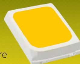
Ciò consente di applicare una potenza superiore poiché il chip dissipa il calore in modo più efficace sul PCB.
